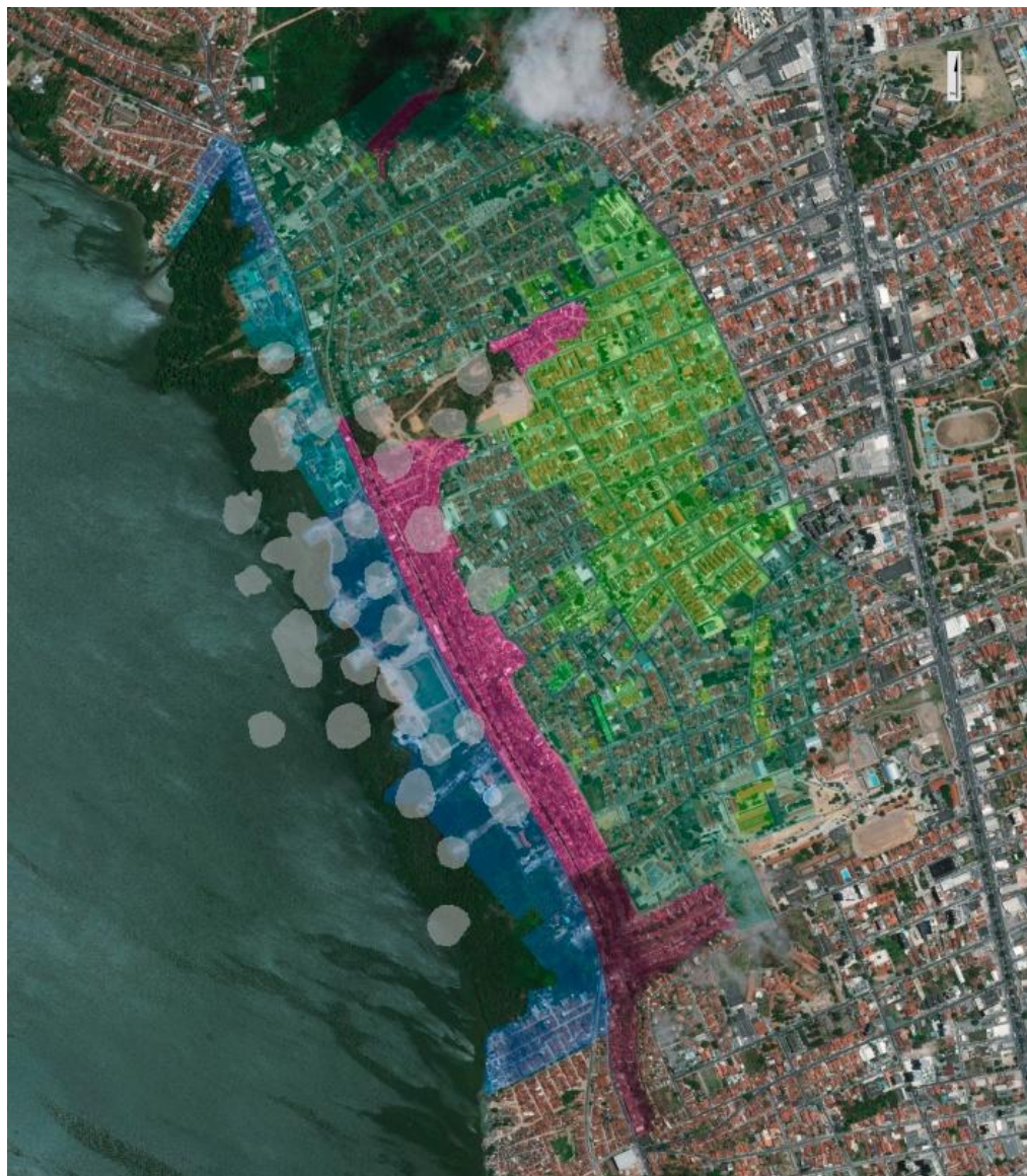
Figura 17 – Mapa da área de “danos” causados pelo afundamento do terreno junto à Lagoa Mundaú – Bairros Pinheiro, Bebedouro e Mutange (Defesa Civil de Maceió / CPRM).
