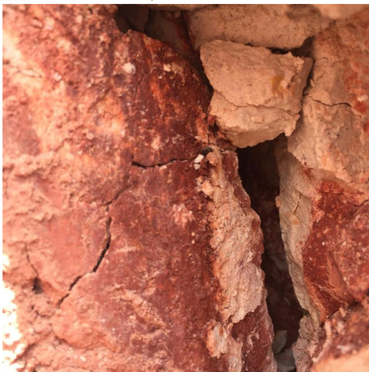
Figura 23 – Estrias em plano de falha normal, conjugada com a da Figura 22, cortando o Grupo Barreiras. Dados pareados plano//estrias, representando direção do mergulho/mergulho//sentido do caimento/caimento → 292/75//292/75, normal.
